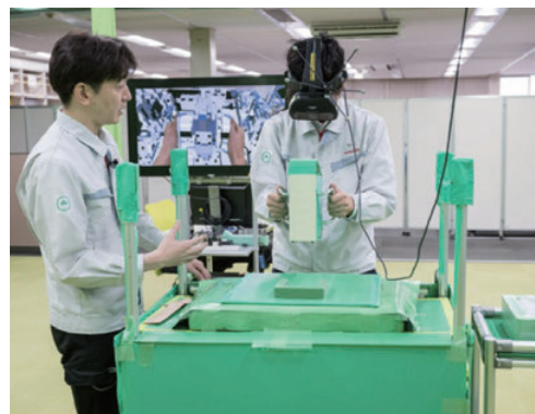
利用数字技术的作业模拟测试。佩戴头戴式显示器 (HMD) 的作业人员可以看到照片后方的显示器影像。
